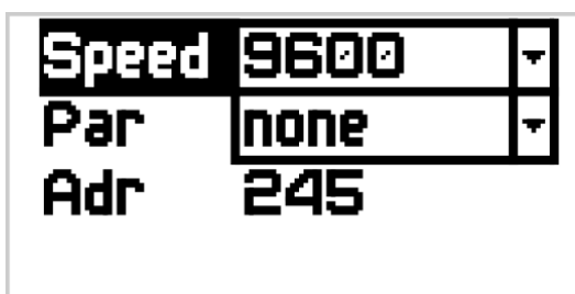
Рисунок 3.14 – Настройки протокола связи по протоколу RS-485
