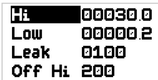
Рисунок 3.11 – Установка предельных значений по току
